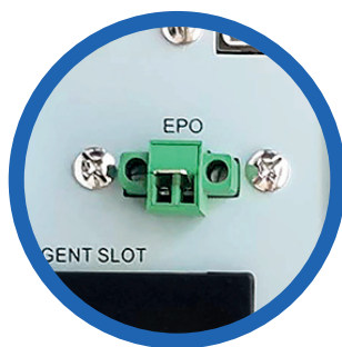
Apagado de emergencia (EPO)
