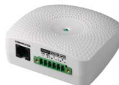
Tarjeta opcional: EMD (Dispositivo de monitoreo ambiental)
