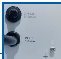
Breaker de circuito de protección
